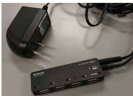
←USB ハブは、左の画像のように、必ず AC アダプタと呼ばれるコンセントから電源供給を受けるタイプを使用してください。
